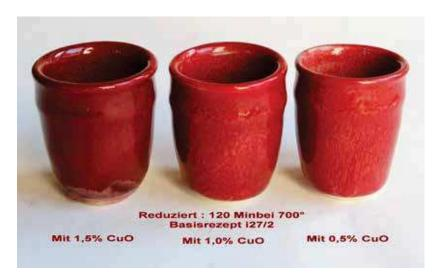
Pieza de la izquierda con 1.5% CuO, la del medio 1% CuO y a la derecha con 0.5 CuO. Estas piezas con 1.5 CuO muestran como de intensa es la prueba con reducción.
