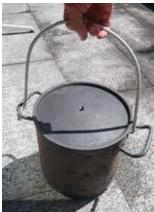
Las piezas para reducir se colocan en el modulo insertado, que a su vez se eleva 8 cm sobre un soporte en el contenedor metálico. Para la manipulación se usa un asa, lo que también me permite transportar el contendor cuando está caliente.
