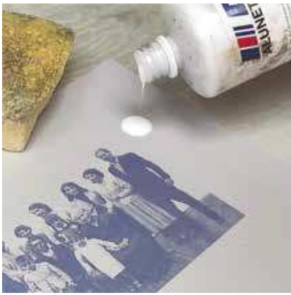
29. Limpiamos la plancha al acabar la tirada con un producto específico usando un trapo o papel.
