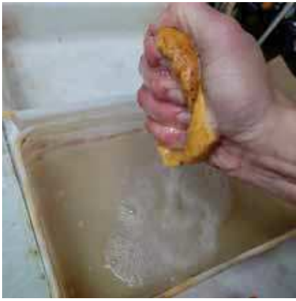
17. Y escurrir en una cubeta de agua sucia. se intercala pasar la esponja humeda con el entintado hasta que la plancha reciba suficiente tinta.
