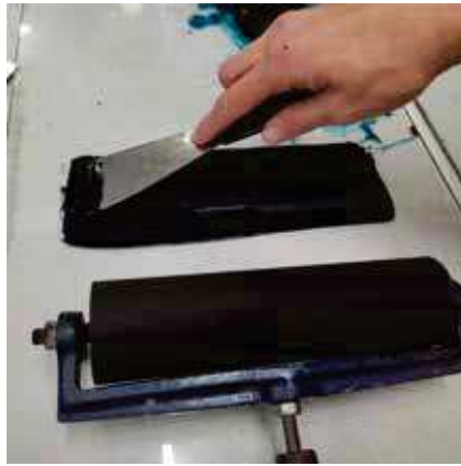
10a. Preparamos nuestra tinta a partir de una tinta de litografia a la que añadiremos pigmentos ceramicos, un fundente y aceite de lino o pomada para tintas.
