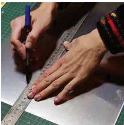
23. Plancha de offset. Marcamos y recortamos por el reverso de la plancha a la medida deseada.
