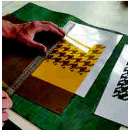
2. Medida y corte de las planchas de polímetro.
