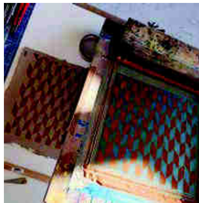
26. Pantalla de serigrafía y la plancha estampada.
